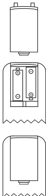
**NOTA:** Al cambiar las pilas siempre es recomendable reemplazarlas todas a la vez. Si no va a utilizar el mando a distancia durante un largo periodo de tiempo, también se aconseja retirar las pilas para evitar posibles daños por la corrosión. Las pilas contienen sustancias químicas, por lo que deben eliminarse correctamente, de acuerdo con los reglamentos locales.
